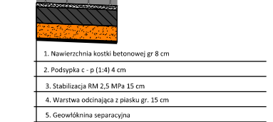
C Projektowana konstrukcja zjazdów
